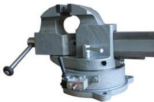
Тиски слесарные пневматические предназначены для механизированного зажима деталей при выполнении различного вида слесарных работ. Пневматические слесарные тиски снижают физические затраты на зажим детали, время для зажима заготовки. Пневматические тиски способны быстро зажимать детали в течение нескольких секунд с усилением 1,5 тонны без применения силы человека.
