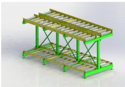
Роликовый конвейер (рольганг) состоит из группы роликов, оси которых закреплены в раме, устанавливаемой на стойках. Рольганги используются для перемещения насыпных грузов (контейнеров, поддонов, ящиков, коробок, паллет, штабелей плитных и листовых материалов, длинномерных грузов, например металлопроката, лесо- и пиломатериалов, брусков и т.п.), в случае, когда применение ленточных конвейеров невозможно или нецелесообразно.
